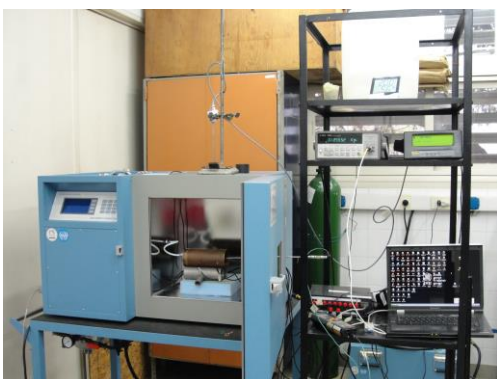
Fig. 2. Generador con SPRT adicional y Sub-cámara de cobre.
