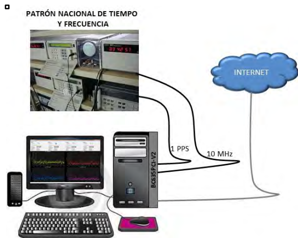
Fig. 5. Diagrama esquemático del sistema de medición incluyendo la tarjeta BC635PCI-V2.
