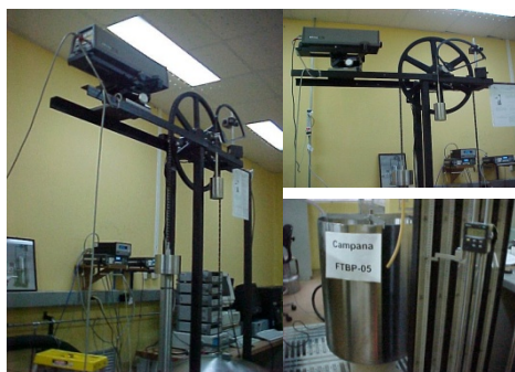
Figura 5. Foto de la medición del diámetro y desplazamiento lineal de la campana.
