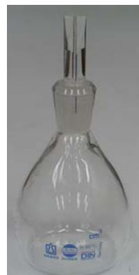
Fig. 1 Patrón de transferencia tipo picnómetro Gay-Lussac para determinación de densidad de líquidos.
