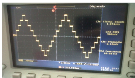
Fig. 9 Señal triangular generada por una de las fuentes de corriente programables con 16 escalones.
