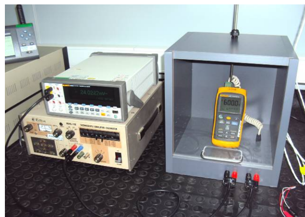
Fig. 3. Recinto para calibración, incluye soporte para la RTD y conexiones para los equipos.
