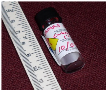
Fig. 1. Imagen de la muestra VAMAS, tal como se recibió. Consiste de una solución de NTCSP en 1 % v/v de desoxicolato de sodio.
