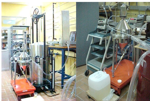
Figura 6. Foto de calibración de la campana mediante desplazamiento de aceite, técnica gravimétrica.
