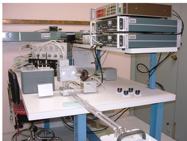
Fig. 2. Aspecto general del puente Maxwell-Wien.
