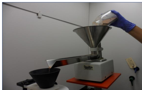
Fig. 8. Proceso de subdivisión del músculo de bovino liofilizado.
