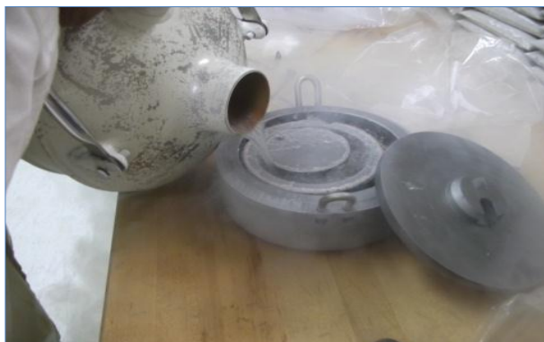
Fig. 7. Molienda criogénica del músculo de bovino de tamaño de partícula de 300 \mu\text{m} y 250 \mu\text{m}
