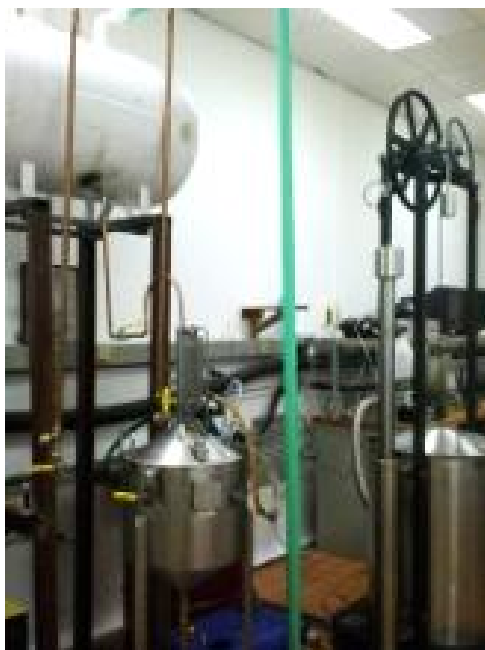
Figura 7. Foto de calibración de la campana mediante desplazamiento de aceite, técnica volumétrica.
