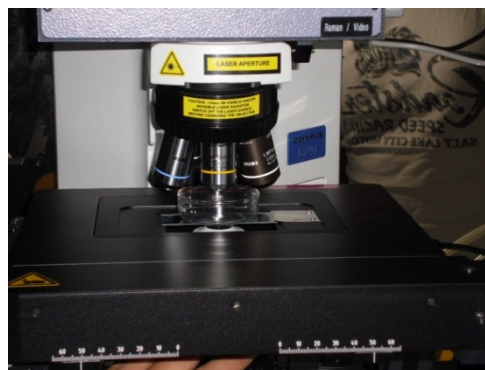
Fig. 3. Imagen de la platina del espectrómetro Horiba Jobin Yvon. Una gota de la muestra se colocó sobre la superficie de una placa de vidrio.
