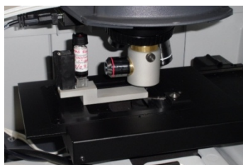
Fig. 2. Imagen del accesorio Raman Macro sampler Simplex Scientific LLC 208-9001-01 insertado en el objetivo del espectrómetro Raman DXR.
