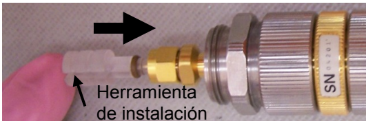
Fig. 8. Uso de la herramienta de instalación en la línea de transmisión "ID 2-7 GHz".
