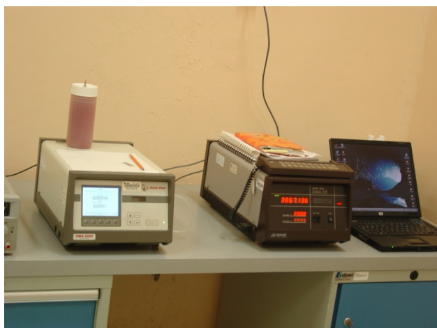
Fig. 3 Densímetros utilizados para indicar el periodo de oscilación de las muestras.
