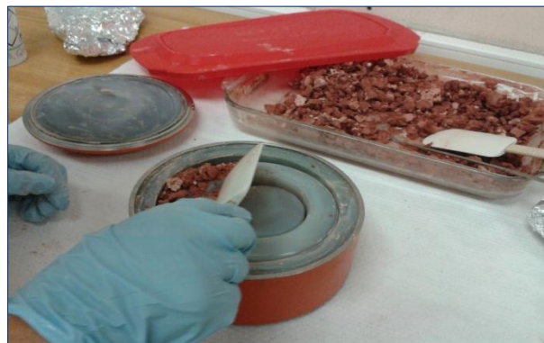
Fig. 5. Proceso de molienda del músculo liofilizado utilizando el molino de discos oscilantes.
