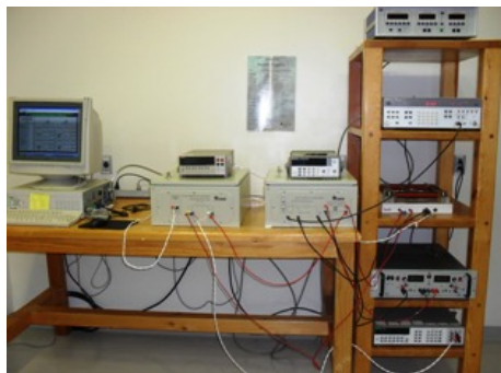
Fig. 4 Sistema de medición de propiedades magnéticas de aceros eléctricos, por el método Epstein, desarrollado en el CENAM.
