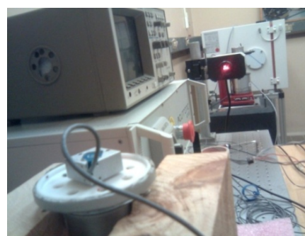
Fig. 6. Montaje para el análisis de sensibilidad utilizando un vibrómetro rotacional para medir la velocidad angular.
