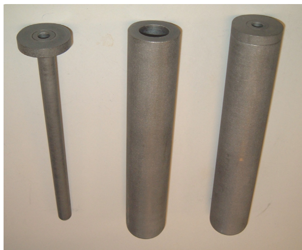
Figura 1. Piezas de grafito para la construcción de la celda del punto de solidificación del cobre.
