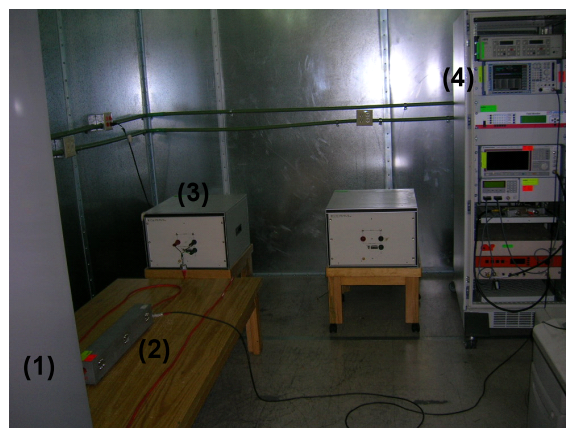
Fig. 3. Colocación del conjunto de prueba. (1) EBP, (2) Pinza de absorción, (3) LISN, (4) Receptor EMI.
