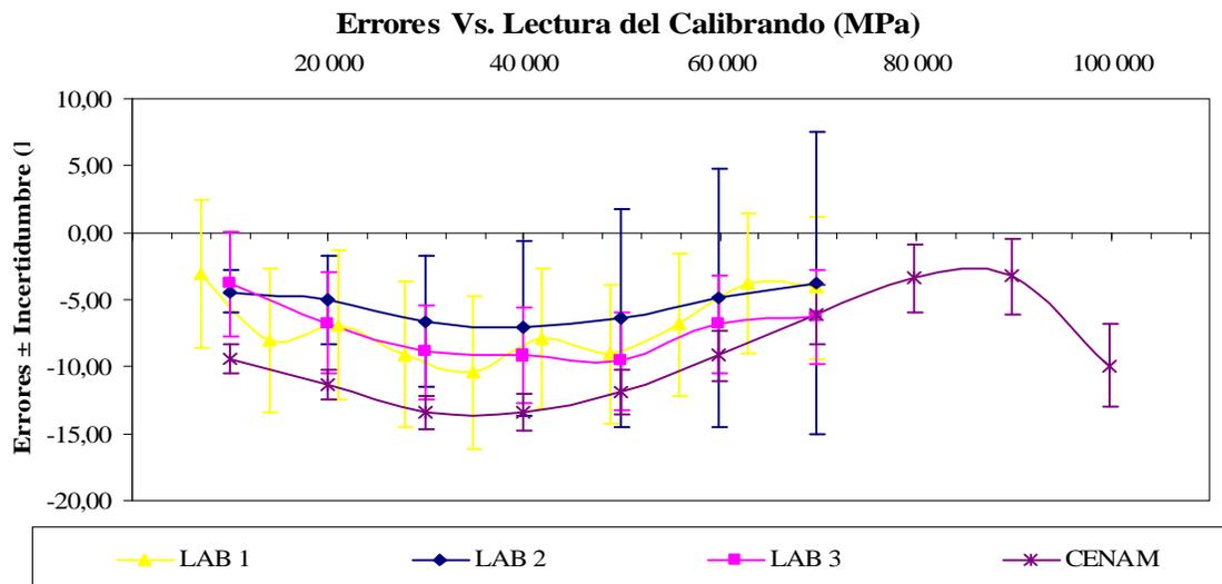
El dispositivo de comparación mide presión relativa con un transductor de cristal de cuarzo que mide presión absoluta. De tal forma, que la presión relativa la obtiene al sustraer la presión atmosférica del lugar a la lectura del transductor. Por lo tanto las lecturas del dispositivo de comparación presentan desviaciones por causa del cambio en la presión atmosférica durante la realización de la calibración.
