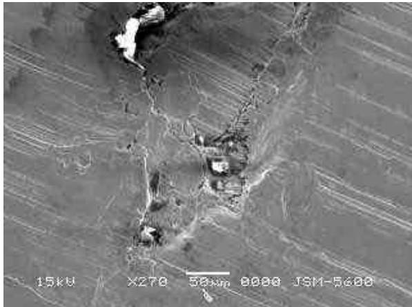
Fotomicrografía 6. Imagen de electrones secundarios de desgarramiento presentado en pieza automotriz.
