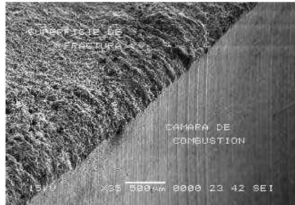
Fotomicrografía 4. Imagen de electrones secundarios de componente automotriz fracturado.
