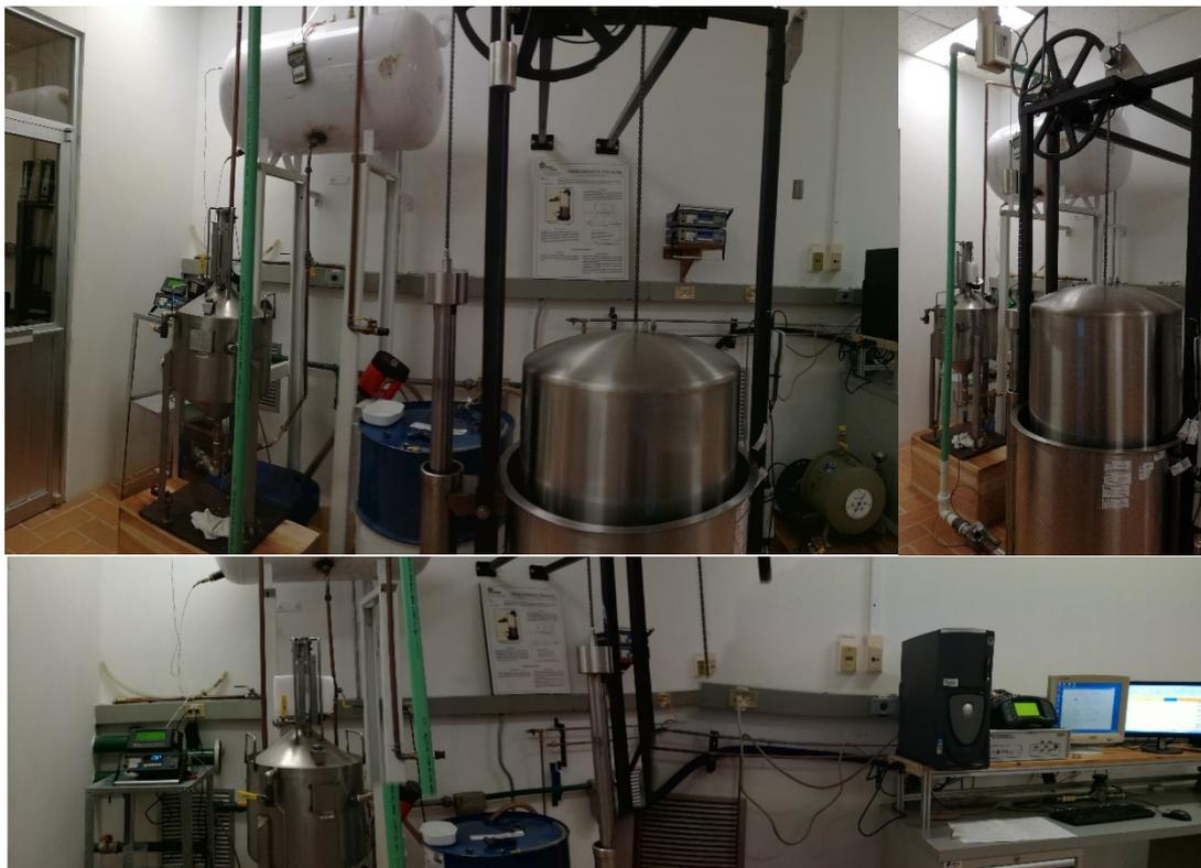
Figura 1. Calibración del Patrón de Flujo Volumétrico de Gas por el método volumétrico.
