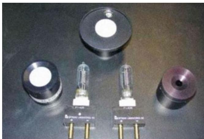
Lámparas de trabajo y detectores usados para medir intensidad luminosa
