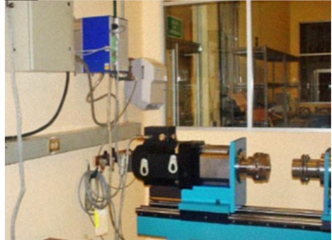
Patrón nacional de par torsional de 2 kN•m antes y después de adaptar el servomotor con freno
