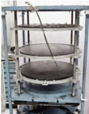
Sistema para la medición de la conductividad térmica de materiales de construcción
