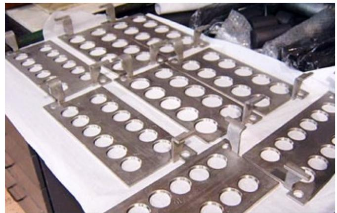
*Habilitado con proceso de pailería, maquinado con fresadora CNC y ensamble con soldadura TIG*
