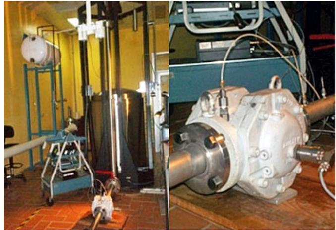
Instalación del medidor de transferencia usado en la comparación clave CC.FF.K6b contra el patrón nacional de flujo de gas tipo campana FTBP20
