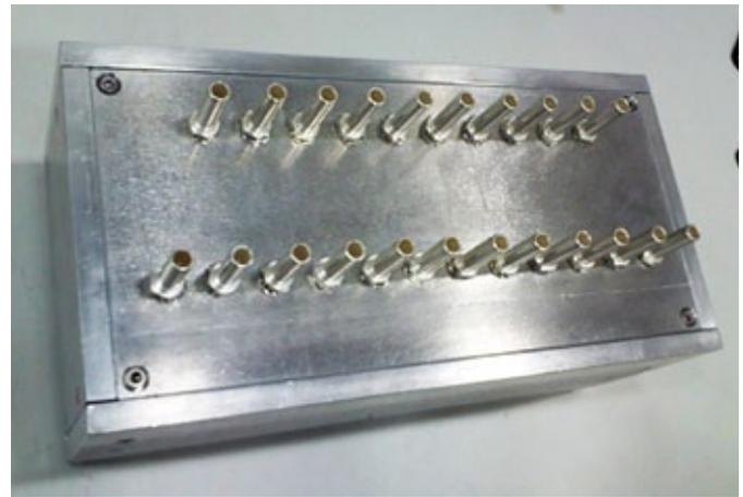
Dispositivo de transferencia de resistencia tipo Hamon
