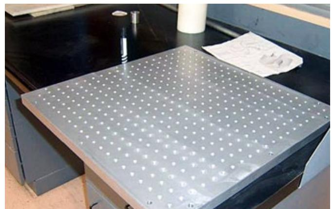
*Parte de inferior de cámara con un arreglo rectangular de barrenos y maquinada en fresadora CNC*
