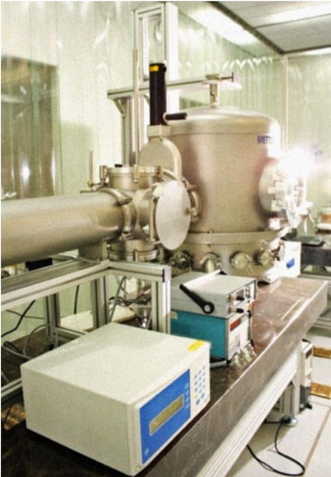
Equipos de monitoreo ambiental instalados en la comparadora de masa para el manejo del Patrón Nacional
