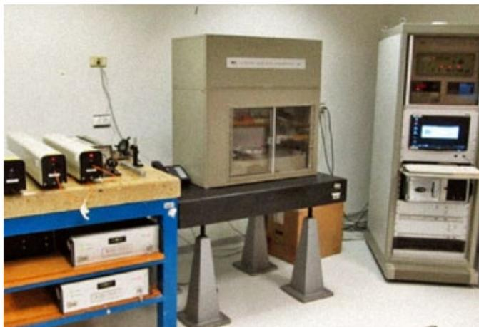
*Interferómetro de bloques patrón*
