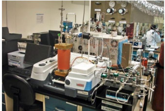
Sistema de referencia de infrarrojo para análisis de gases
