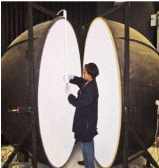
Proceso de calibración de lámparas patrón para flujo luminoso total
