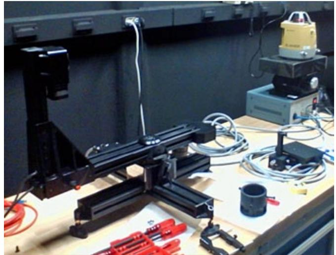
*Gonio-fotómetro para medición de fuentes y luminarios de leds*
