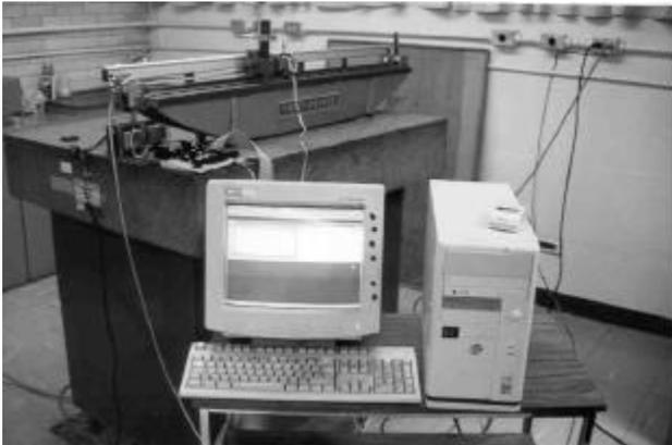
**Fig. 5** Máquina para la calibración de reglas.
