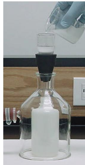
*Fig. 2 Sistema de filtración*
