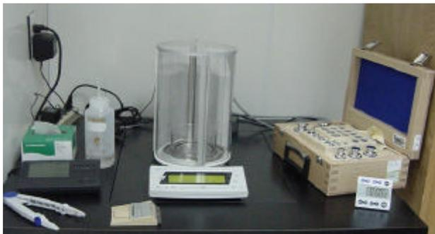
*Fig. 1 Balanza analítica y accesorios de pesada*
