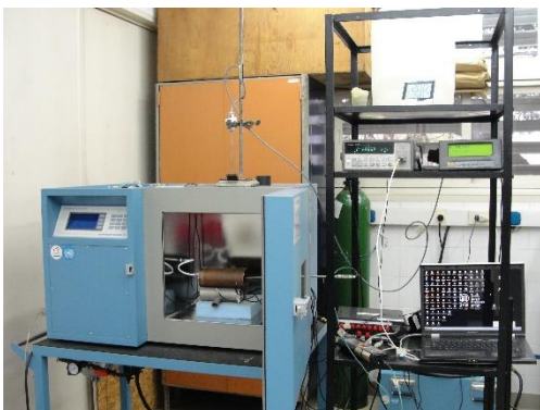
Fig. 2. Generador con SPRT adicional y Sub-cámara de cobre.
