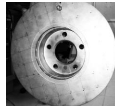
Fig. 2. Disco de frenos con mallado y el montaje de un acelerómetro en condición libre.
