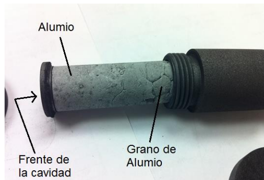
Fig. 1. Casi al finalizar el proceso de llenado, aún se observaban las fronteras de grano.
