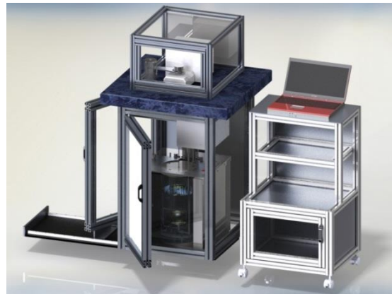
Fig. 2. Sistema automático para la medición de la densidad de sólidos y líquidos.
