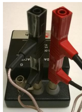
Fig. 5. Colocación de conectores.
