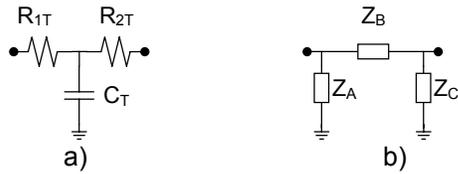
**Fig. 3** a) Arreglo de impedancias en forma de circuito "T", b) Circuito equivalente delta del circuito "T".
