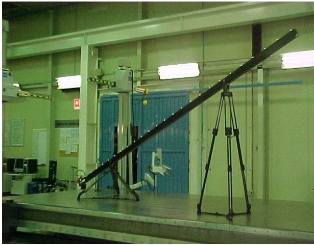
Fig. 2 Barra de 5 m. de fibra de carbón con esferas cerámicas orientada en diagonal espacial.
