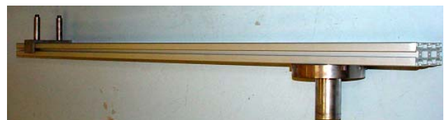
Figura 9. Estructura soporte para instrumentos de brazos de palanca.
