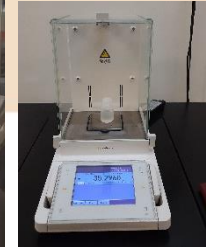
3. Empleando agua doble subdestilada, se realiza la disolución para el aforo de las muestras mediante preparación gravimétrica
