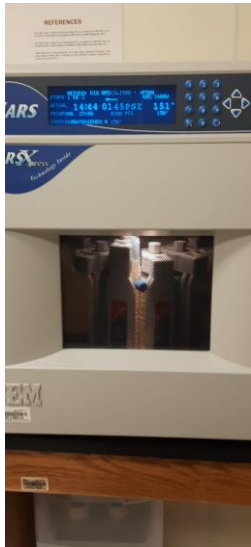
1. Digestión en el CNM-SR-620-024 Sistema de referencia de preparación de muestras por horno de microondas, previa preparación gravimétrica
