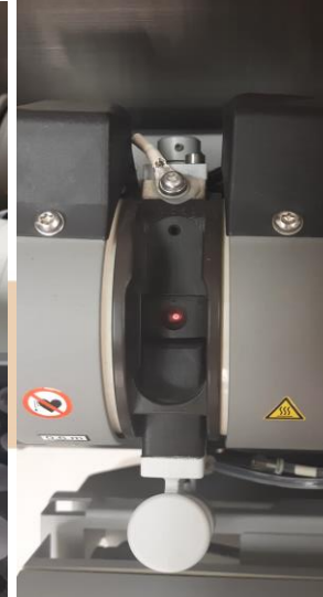
4. Medición con el CNM-SR-620-018 Sistema de referencia de medición por espectrofotometría de absorción atómica por horno de grafito (AA800)
