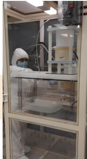
3. Empleando agua doble subdestilada, se realiza la disolución para el aforo de las muestras mediante preparación gravimétrica
