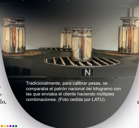
La programación y la automatización liberan al técnico de la necesidad de pasar horas frente al equipo. La calibración se hace prácticamente sola. (Foto cedida por LATU).
