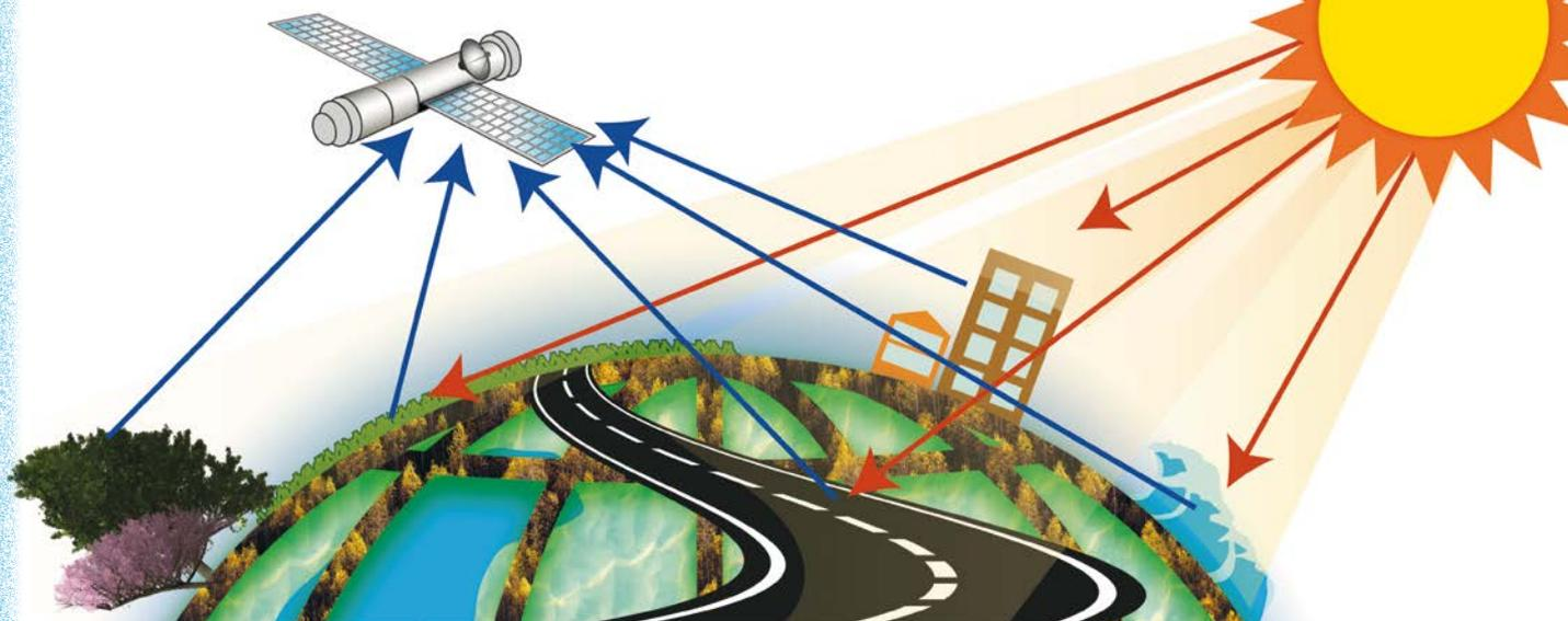
Existen dispositivos de teledetección activos y pasivos. Los activos son aparatos electromagnéticos y acústicos que emiten impulsos y luego captan la señal de retorno, que al ser procesada se convierte en una variable meteorológica. Un ejemplo clásico es el radar, y el sodar.
