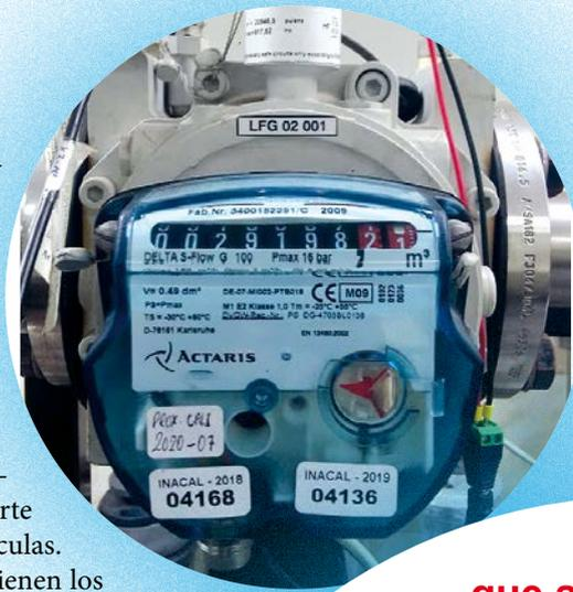
El medidor de gas rotativo (*Roots meter*) es uno de los patrones que se mantienen en INACAL con los cuales se calibran los instrumentos de flujo que forman parte de los muestreadores de partículas. Foto cedida por INACAL.
