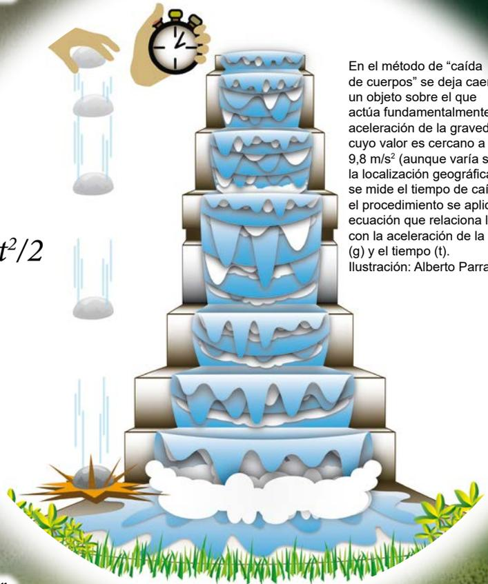
En el método de “caída de cuerpos” se deja caer un objeto sobre el que actúa fundamentalmente la aceleración de la gravedad cuyo valor es cercano a los 9,8 m/s<sup>2</sup> (aunque varía según la localización geográfica) y se mide el tiempo de caída. En el procedimiento se aplica una ecuación que relaciona la altura (h) con la aceleración de la gravedad (g) y el tiempo (t).
