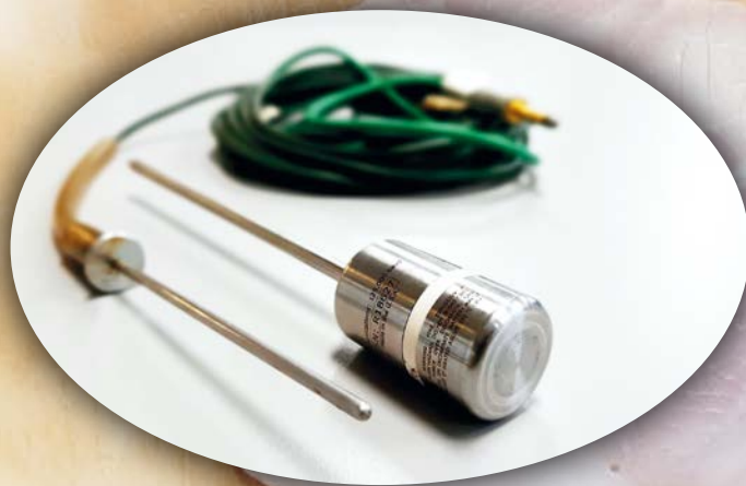
Termómetros tipo utilizados durante la validación de procesos térmicos: termopar tipo T y sensor de resistencia de platino inalámbrico. Foto cedida por el LATU.
