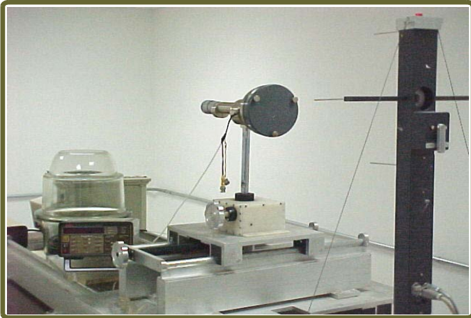
Patrón Nacional de tasa de dosis absorbida en aire: cámara de extrapolación (distancia entre electrodos variable con colector de 30 mm de diámetro). La cámara de extrapolación y electrómetro tienen un sistema de posicionamiento para conservar la geometría fuente radiactiva-cámara.
