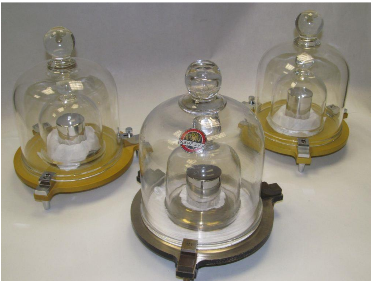
Fig. 8 El patrón nacional de masa, el k21, y las dos copias adicionales del IPK, el k90 y el k96, las cuales se mantienen en el CENAM. Prototipos de platino – iridio (90 % Pt, 10% Ir)
