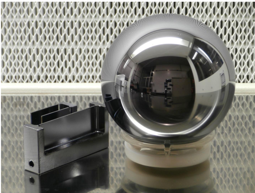
Fig. 5. Monocristal de ^{28}\text{Si} para el método XRCD, ( https://phys.org/news/2015-07-precise-avogadro-redefine-kilogram.html ).
