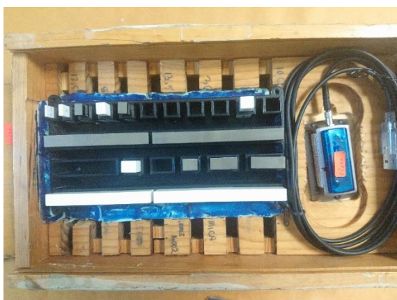
c) Caja con bloques y data logger
