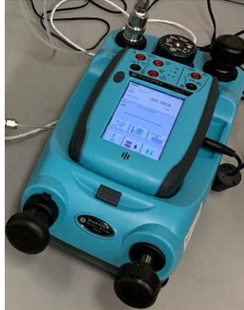
Conectar el PT al sistema de medición del laboratorio. El PT tiene un conector hembra NPT (de 1/8 in) que se debe de utilizar durante las mediciones.
