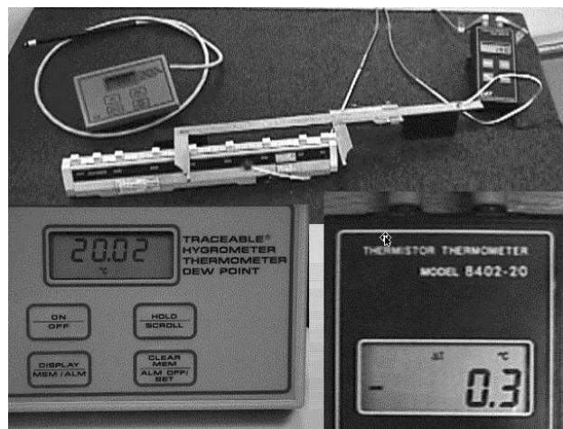
Fig. 1 Ejemplo de medición de temperaturas en la calibración de un calibrador vernier.
