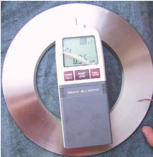
**Fig. 3** Medición de Rugosidad
