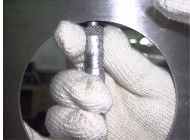
**Fig. 5 Medición Diámetro Orificio**
