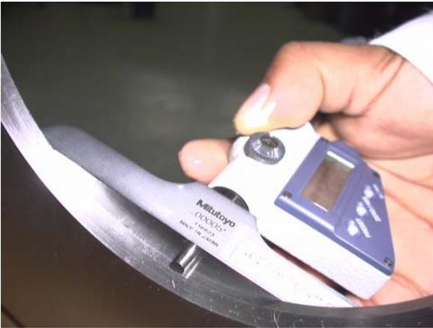
**Fig. 6** Medición Espesor del orificio de la placa
