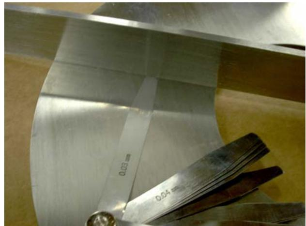
**Fig. 2** Medición de Desviación de Planitud
