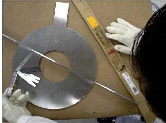
**Fig. 1** Medición de Desviación de Planitud
