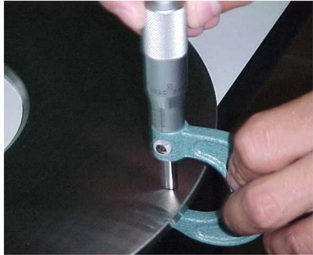
**Fig. 7** Medición Espesor de la placa de orificio
