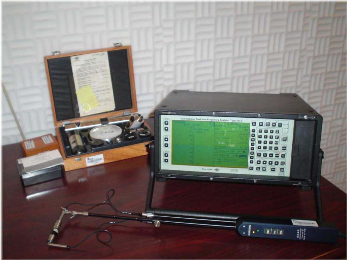
Equipo empleados para la medición de intensidad acústica
