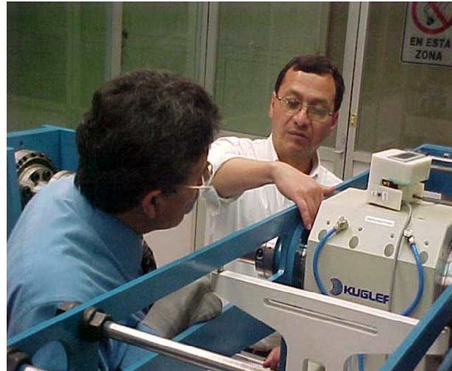
Se realizó la calibración de 2 transductores de par torsional mediante el método primario (alcances de medición de 100 N·m y de 1 kN·m) y de 1 transductor de par torsional por el método de transferencia (alcance de medición de 10 N·m).
