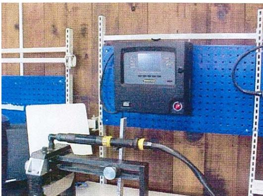
Fig. 10. Atornillador electrónico con controlador y cable.
