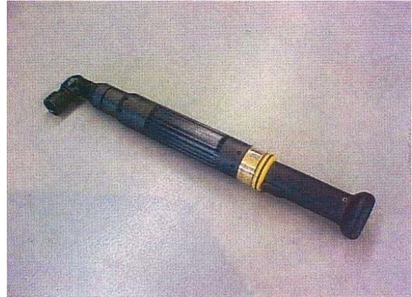
Fig. 11. Atornillador electrónico.
