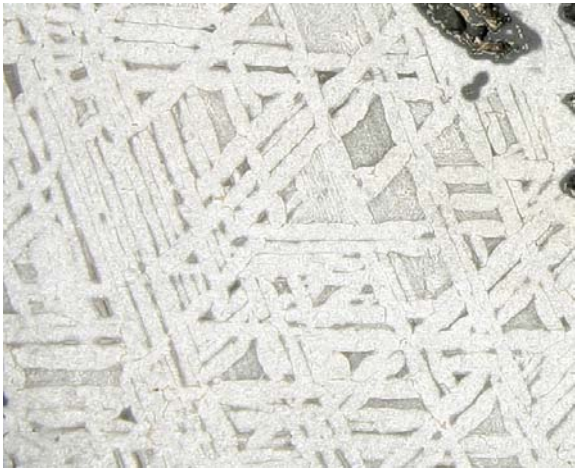
Fig. 1. Textura de Widmånstatten en la meteorita metálica Toluca (ejemplar de la colección del Instituto de Geología, UNAM) amplitud de la imagen: 5 cm.
