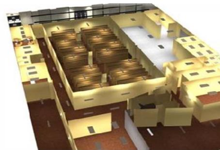
Fig. 7. Simulación en 3D de sótano, lograda con el programa Dialux.
