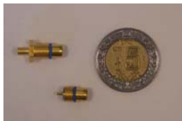
Fig. 5. Modificaciones a conectores tipo OSP.
