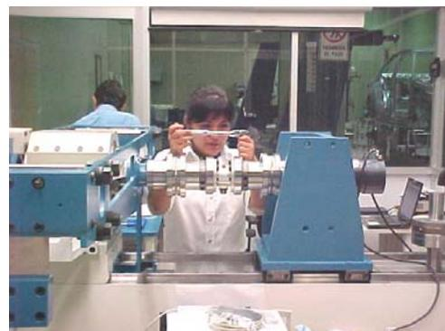
Fig. 10. Instalación de un transductor de par torsional para su calibración en el SHPT-VW-1kN·m.
