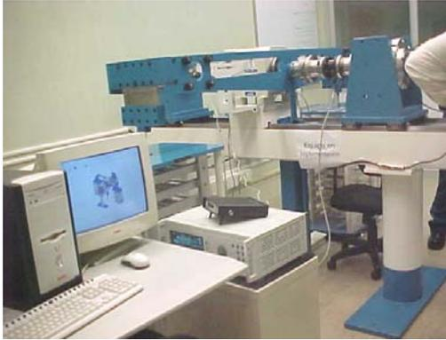
Fig. 11. Sistema híbrido de par torsional de 1 kN·m (SHPT-VW-1kN·m).
