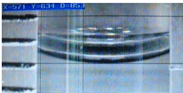
Fig. 2. Ajuste del menisco en la marca del cero de la escala graduada.
