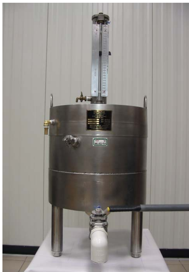
Fig. 1. Fotografía del patrón volumétrico de cuello graduado utilizado en la comparación.
