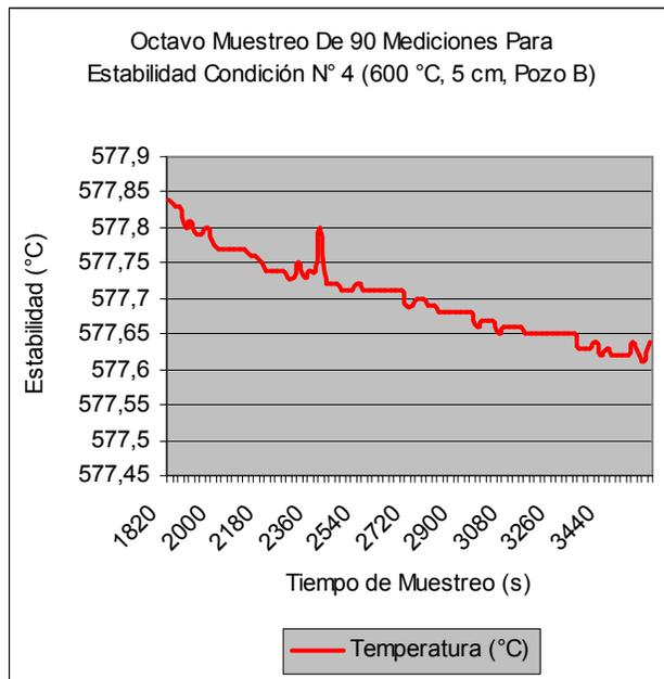
**Gráfico 11.** Octavo muestreo de 90 mediciones para la estimación de estabilidad térmica, condición N°4.
