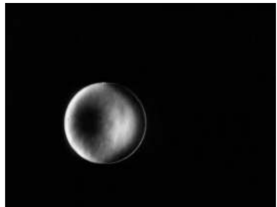
Figura 5. Paraboloide de revolución D = 250 \text{ mm} , f/5.5 y b = -1 .
