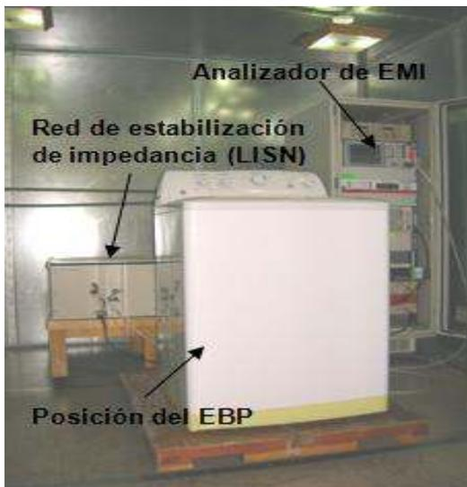
**Figura 2:** Configuración de los equipos de medición.
