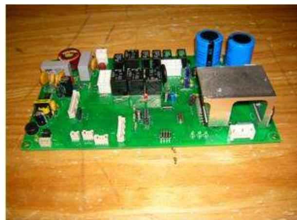
**Figura 9.** Tarjeta control para motor trifásico.
