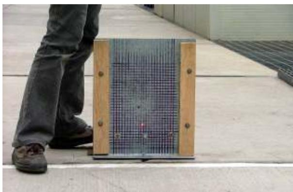
**Fig. 3** Blanco usado para verificar distanciómetros.
