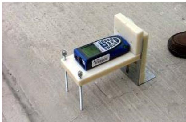
**Fig. 2** Soporte para distanciómetros Láser de bolsillo (DLB).
