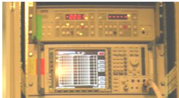
Fig. 6: Equipos de medición y control para las pruebas de EMI radiadas.
