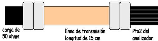
**Figura 11.** Configuración experimental para estimar la Directividad efectiva
