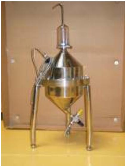
Fig. 1 Imagen de uno de los PT de 20 L usado durante las CC CCM.FF-K4, EURAMET.M.FF-K4, SIM.M.FF-K4 y APMP.M.FF-K4.
