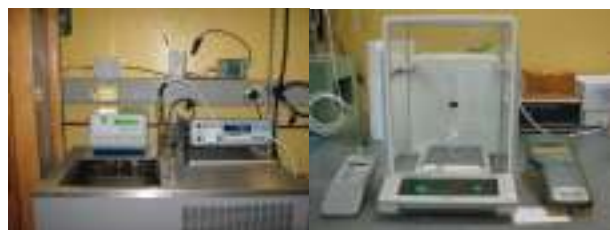
Figura 3. Instalación usada por CENAM para la calibración de los recipientes.
