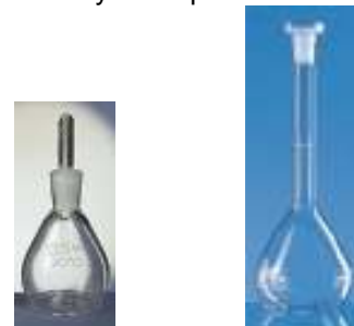
Figura 1. Picnómetro tipo gay-Lussac y matraz volumétrico aforado.
