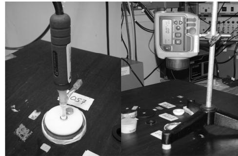
Fig. 8 Medición de la temperatura de la cavidad con PRT, con tapón, y después con IRT.
