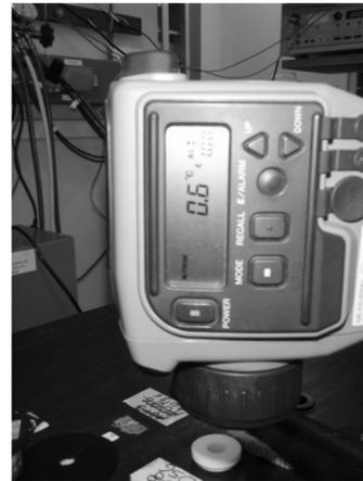
**Fig. 4** Medición de la temperatura de la cavidad con IRT
