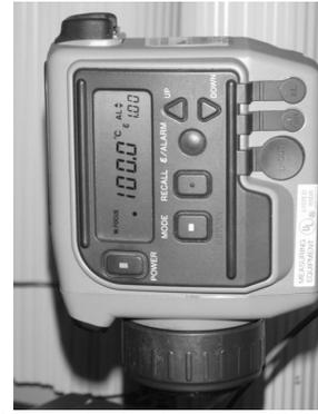
**Fig. 12** Medición de la temperatura de la cavidad con IRT retirando el tapón.
