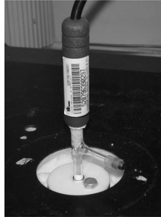
**Fig. 11** PRT dentro de la cavidad con tapón
