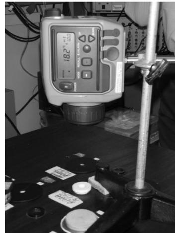
**Fig. 5** Arreglo experimental que muestra el tapón de hule tapando la apertura de la probeta.
