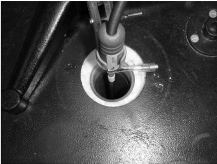
**Fig. 9** PRT dentro de la cavidad sin tapón, con la cavidad dentro de un horno de tres zonas.
