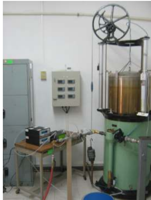
Figura 3. Foto de instalación de la tobera de flujo crítico para la calibración del volumen de la campana American Meter, modelo 110 L.
