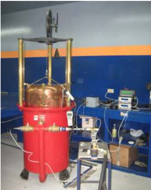
Figura 4. Foto de instalación de la tobera de flujo crítico para la calibración del volumen de la campana Rockwell, modelo 5 ft 3 .
