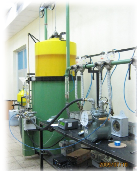
Figura 6. Foto de la evaluación del volumen de la campana SAMGAS, modelo 500 dm 3 , usando el medidor tipo diafragma.
