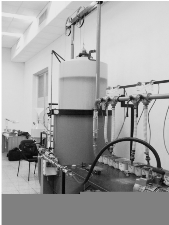
Figura 2. Foto de instalación de la tobera de flujo crítico para la calibración del volumen de la campana SAMGAS, modelo 500 dm 3 .
