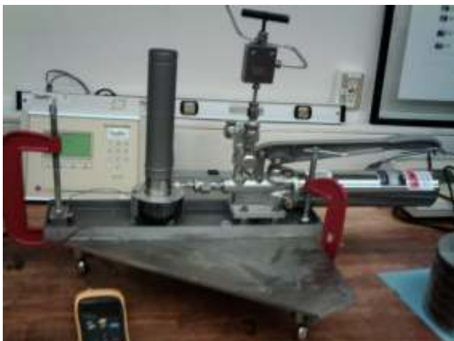
Figura 2. Ensamble del pistón cilindro en el poste de montaje y con el porta masas.
