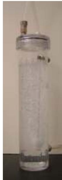
Figura 3. Saturador de vapor de agua por burbujeo.
