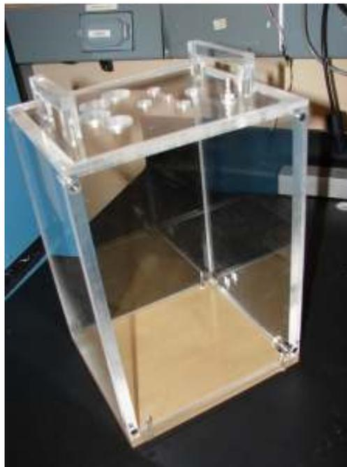
**Figura 5.** Cámara de prueba del generador de humedad por flujo dividido.
