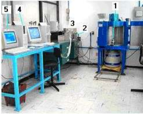
Fig. 1. Sistema de espectrometría gamma, usado como Patrón Nacional de Actividad. Se indican: 1. Detector, 2. Fuente de alimentación, 3. Amplificador, Convertidor Analógico Digital, Analizador Multicanal, 4. Computador. 5. Monitor de video.
