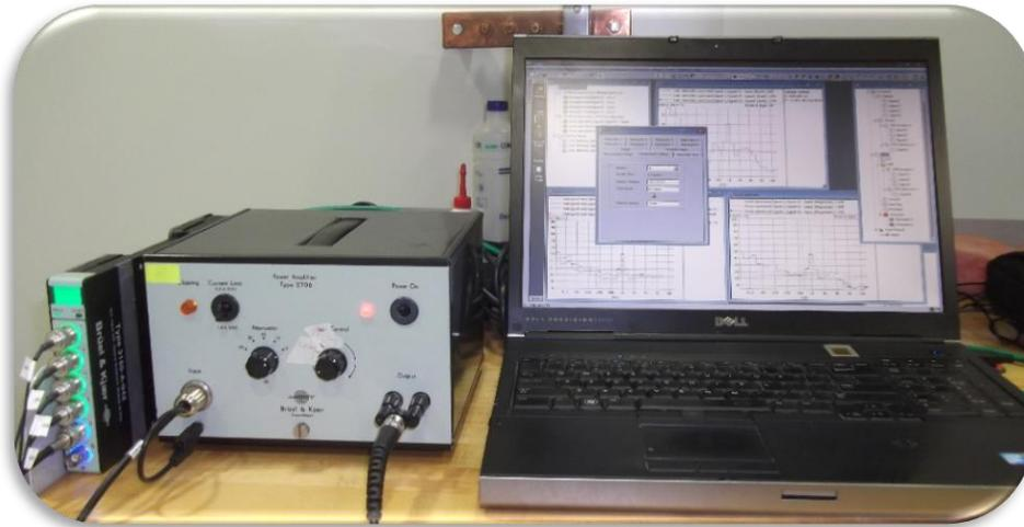
Figura 36.-Sistema de adquisición y software PULSE.
